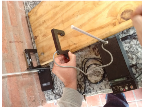
Figura 3: Empleo de compuertas de tiempo con fotodetectores para determinar distancia s sobre el plano vs t
