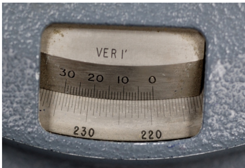
Figura 2.9. Detalle del nonius del espectrogoniómetro.
