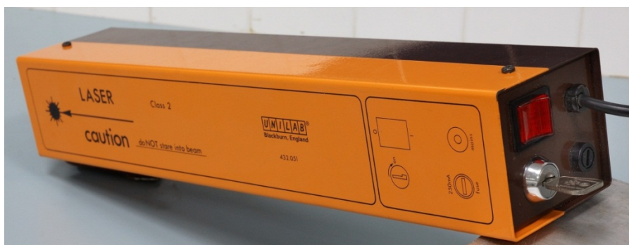
Figura 2.5. Doble interruptor del láser de He-Ne.
